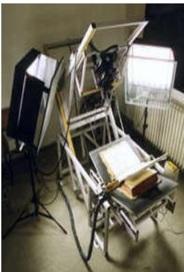
Está provista de un soporte para una cámara profesional que lleva un escaneador posterior que se mueve sin vibraciones. El modelo fue reiteradamente probado antes de su puesta en funcionamiento en Julio de este año
